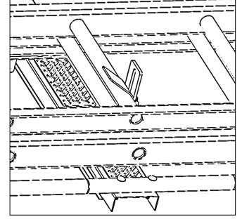
BE SURE THE LADDER HOOKS ARE FIRMLY AGAINST THE LADDER STEPS OR RUNGS.
