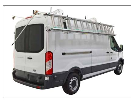
**LEFT IMAGE:** LADDER RACK ON A MID-ROOF VAN IS IN THE DOWN POSITION. NOTE IT IS EASY TO REACH THE DETACHABLE HANDLE WHICH CAN BE STORED INSIDE THE VAN.
